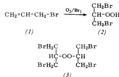
Die Umwandlung (2)  $\rightarrow$  (3) war nicht möglich. Bei der Einwirkung von Säuren und durch thermische Zersetzung entsteht aus (2) 1,3-Dibrompropan-2-on. Die Reduktion von (2) mit KJ/Eisessig oder LiAlH4 führt zum 1,3-Dibrompropan-2-ol.
